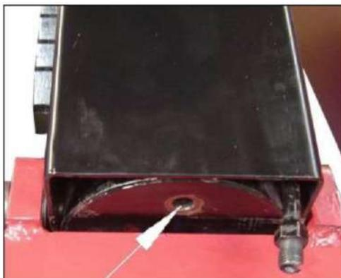
Предохранительная защелка и зубчатый модуль - это детали, которые гарантируют безопасность персонала под машиной в случае отказа других средств защиты. Поэтому убедитесь в целостности зубчатого модуля и в том, что предохранительная защелка полностью закрыта. (Рисунок 9)
